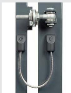
Il nuovo cavetto anti-caduta in acciaio inox per cancelli ad anta battente è disponibile nelle versioni: B-Safe da 220 mm di lunghezza e 4 mm di spessore; U-Safe da 300 mm di lunghezza e 5 mm di spessore. Caratteristiche tecniche: sono certificati nel rispetto della norma EN 12604; per ante
